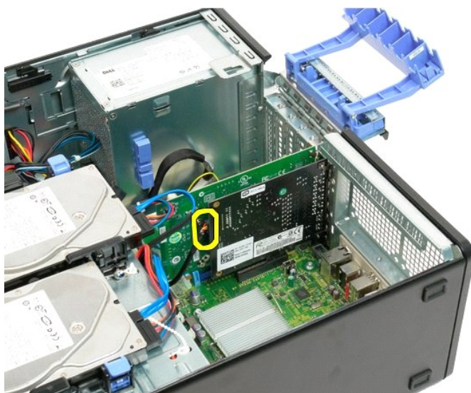
7. Emelje felfelé a bővítkártyát, és vegye ki a számítógépből.
